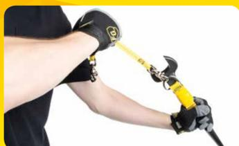
Platzieren Sie den Wärmeschrumpfring über einem Befestigungspunkt, der durch das Quick Wrap Tape verstärkt wird. Erwärmen Sie das Quick Wrap Tape mit einer Heißluftpistole so lange, bis sich die Verbindung vollständig zusammengezogen hat. Verbrennen Sie dabei die Wärmeschrumpfringverbindung nicht.
